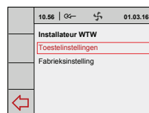
Figuur 6 Parameter CV+WTW activeren bij Renovent Sky 150 & Sky 200 & Sky 300 met Brink Air Control
